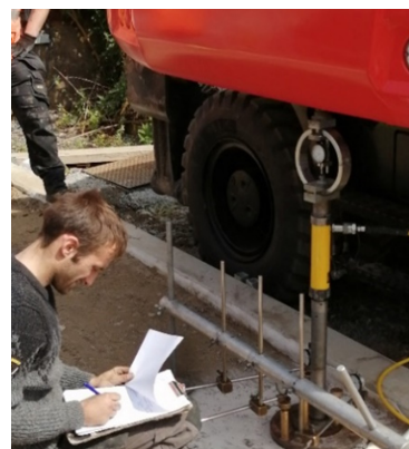
Figure 3 - Essai à la plaque sur sol stabilisé
