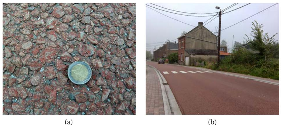
Figure 4 : Exemples de granulats de couleur utilisables pour la fabrication d'enrobés bitumineux colorés
